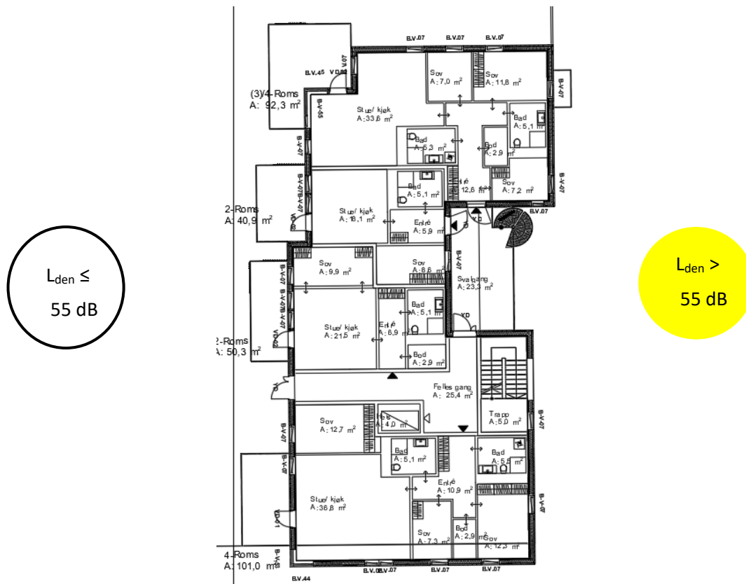
Figur 6 - Eksempel på planløsning i bygg A som tilfredsstillers foreslåtte krav til støyuksatt enhet.
